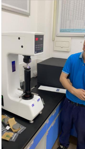
使用洛氏硬度计要注意的问题：1. 洛氏硬度计的稳定性考查：洛氏硬度计不宜经常调整其测量杠杆，应保持其稳定性。可用一、二套较好的标准硬度块，定期在同一硬度块上试验，以考查仪器的长期稳定性，掌握其性能。在硬度试验前，应用与试样硬度值接近的标准硬度块校机，使得试验结果更为可靠。2. 洛氏硬度计加载速度对硬度值影响：加载速度对硬度值影响：当洛氏硬度计主负荷施加速度由2秒变为12秒时对硬度值的影响，低硬度值为0.2HRC中硬度为0.4HRC高硬度为0.6HRC洛氏硬度计主控板固定安装在机体下部的内腔中。盐城表面洛氏硬度洛氏硬度计销售厂家
