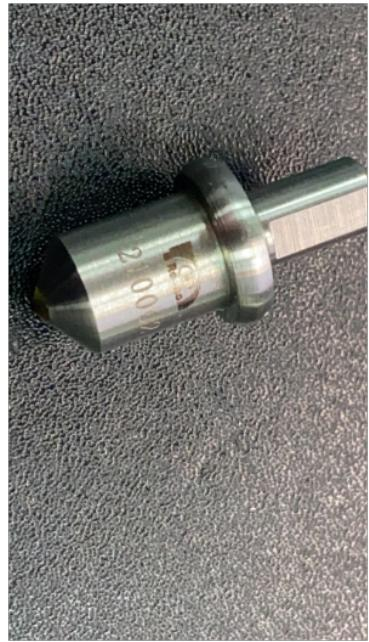
洛氏硬度计压头的保养：压头又分为：1/16、1/8、1/4、1/2等压头规格 如图所示金刚石锥形压头及钢球压头。 洛氏硬度计压头 注意：不要使用磨损或损坏的压头 洛氏硬度计金刚石锥形压头 每月检查金刚石锥形压头的损坏。如果金属体的锥形表面有许多凹痕，操作人员可能已使压头撞击过淬硬的试台。在10倍放大镜下检查压头，如果有明显的损坏，则更换压头。为了避免损坏压头，当取下试台及试件时，用手指保护它。 洛氏硬度计球压头 每天检查球压头的损坏。如果有磨损或变形的痕迹，应更换钢球。更换钢球方法为：通过旋转拧下压头外壳，取下旧的钢球，装上更换的钢球，拧上压头外壳，即更换新钢球工作完成。
