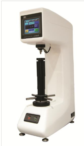
洛氏硬度计故障的分析与排除：1. 主负荷加载后，硬度计指针出现较长时间太转动。原因是砝码吊杆太长，调成短杆就解决了。2. 硬度计主负荷加载后，指针还是静止不动。造成的原因是主负荷没加上，或者缓冲器油针关闭了油孔。解决方法是把硬度计吊杆长度调短，打开缓冲器，调开油针。3. 硬度计加主负荷时，指针转动迅速。主要原因是缓冲器的油针在较大开口位置或者缓冲无油。排除方法，调节油针至合适位置，加油排净空气。4. 硬度计加主负荷时，指针转动缓慢。主要原因有下面几种：缓冲器的油针调节过小，缓冲器油太脏或粘度大，百分表测量杆有较大的摩擦，主轴系统有阻力。分析出原因后，针对进行，油针调节，更换合适机油，消除摩擦，清洗主轴系统。盐城表面洛氏硬度洛氏硬度计销售厂家洛氏硬度计主要用于材料的洛氏硬度测试。
